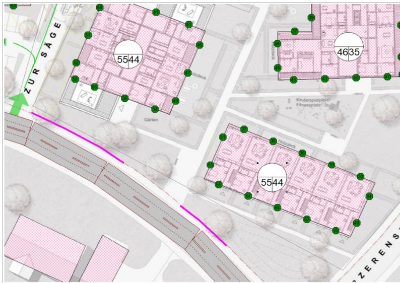
Abbildung 10: Lärmschutzwand  $h \geq 1.5$  m, strassenseitig absorbierend ausgeführt (rote Linie)
