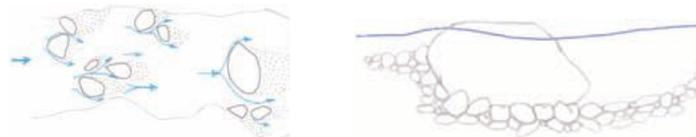
Bei exponierten Richtungswechseln kommen Totholzfaschinen zum Einsatz. Anfang und Ende der eingebauten Faschinen sind zu sichern, um ein Hinterspülen zu verhindern. Länge ca. 5 m. Durchmesser ca. 0.3 m. Der Einbau erfolgt auf Höhe der Nieder- und Mittelwasserlinie.
